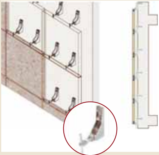
Befestigung von Fassadenplatten mittels Body-Ankern zum Andübeln
